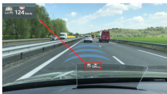
Dans le cas d'un dépassement avec régulateur adaptatif enclenché, si vous ne déboitez pas assez tôt, en ayant mis votre clignotant, votre véhicule va freiner pour adapter l'intervalle de sécurité avec le véhicule qui vous précède. Les conducteurs qui critiquent ce freinage et donc l'usage du régulateur de vitesse adaptatif sont tout simplement des conducteurs qui déboitent trop tard pour effectuer un dépassement et donc ne respectent pas la règle des 2 secondes.
